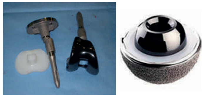
Prótesis de cadera y de rodilla de Oxinium, aleación de óxido de zirconio, que tiene la dureza del metal, pero la baja fricción de la cerámica y es bioinerte.
