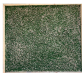
Ejemplos de muestras: Caucho, mezcla de rellenos naturales (corcho y hueso de aceituna) y plástico reciclado
